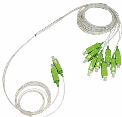
Diviseur optique PLC miniaturisé avec 2 entrées et 8 sorties adapté à la réalisation de la **redondance dans les systèmes GPON**; équipé de la technologie **planar waveguide** qui permet de très faibles pertes d'insertion.
